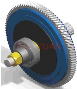
**摩擦式扭力限制器亦稱為安全離合器**，安裝在動力傳動的主、被動側之間，將齒輪夾在彈簧複合式摩擦表面，可以螺帽調整彈簧力以限制其所傳動扭力的大小，當發生過載扭矩超過設定值時，扭力限制器將會產生分離，從而有效保護了驅動機械以及負載，以達**防止過負荷吊重與過捲揚**情況發生。
